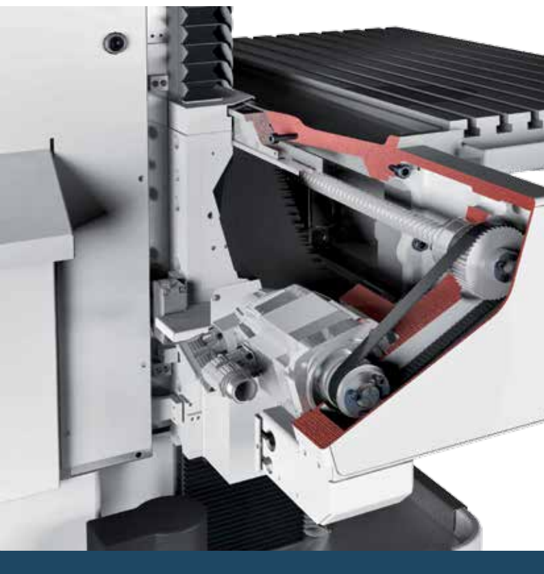
FPS 500M-NC: Вид привода оси X в разрезе
