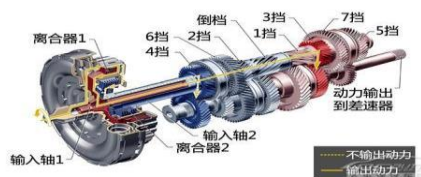
大众7速DSG变速箱工作原理
